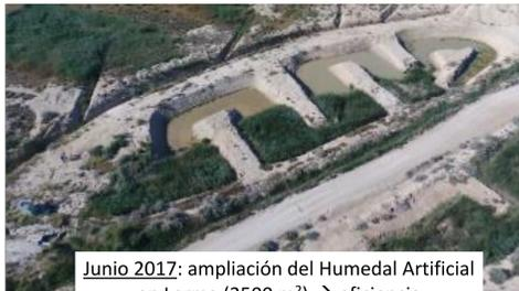
Junio 2017: ampliación del Humedal Artificial en Lerma (2500 m<sup>2</sup>) → eficiencia desnitrificación negligible (caudal 5-15 L/s).
